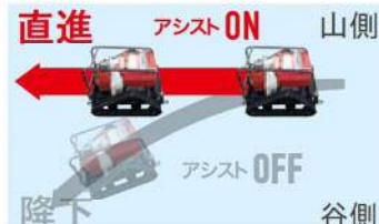
傾斜地における傾斜アシスト機能を搭載。左右それぞれのクローラの回転速度を制御することにより、傾斜地での直進をアシストします。
