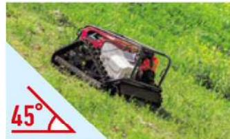
専用設計のクローラーで斜面での走破性は抜群。独自設定のラグにより、地面をしっかりと捉え、最大傾斜45°で安定して走行します。
