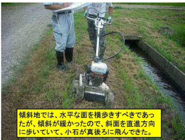
作業時、傾斜地では自走式草刈機を横歩きで使用するが、傾斜がそれほどきつくなかったため、歩きやすい前進で使用していたので石が機体の真後ろの方向に飛んできた。
